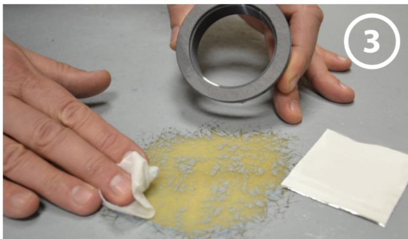
Pulire bene anche l'anello di montaggio. Attendere 5 minuti per fare asciugare sia lo scafo che l'anello di montaggio.
